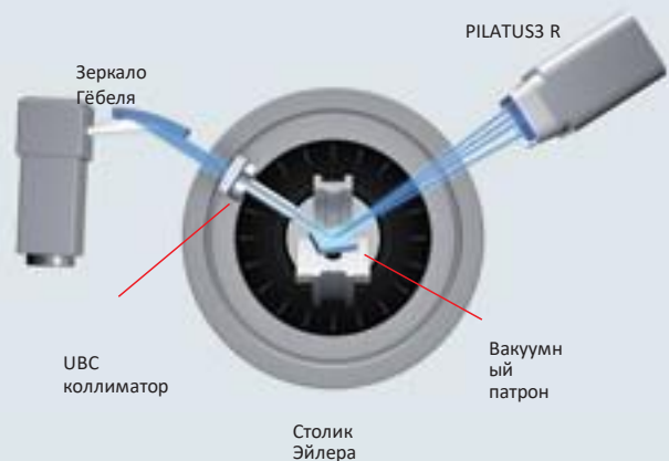
Измерение напряжения в режиме бокового наклона (psi) с помощью PILATUS3 R 100K-A
