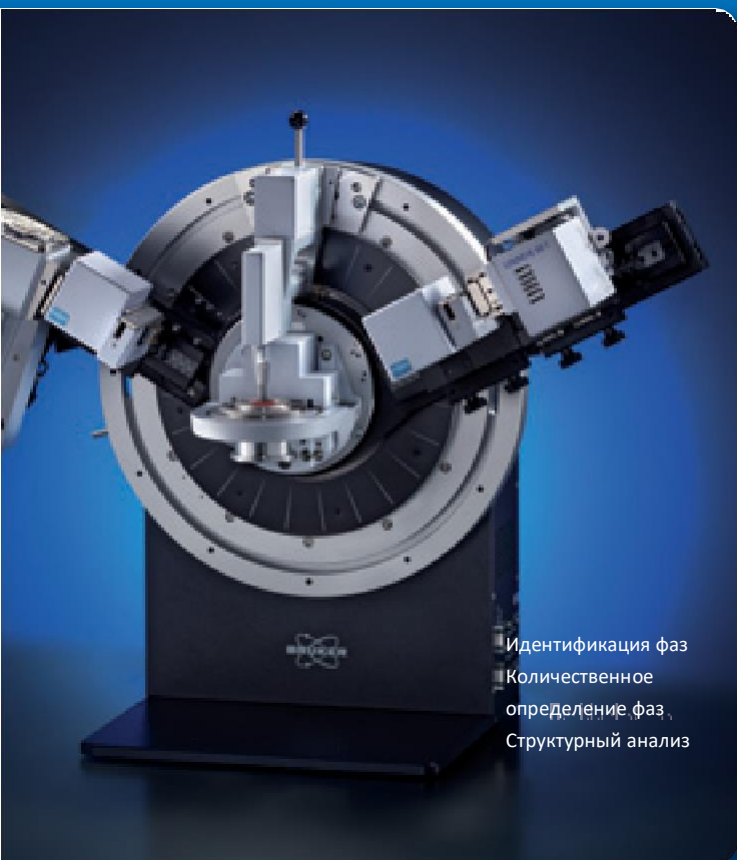
Геометрия Брэгга-Брентано с детектором LYNXEYE XE-T и моторизованным антирассеивающим экраном
