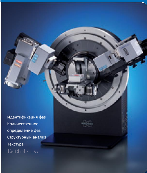
Установка TRIO/TWIN в геометрии Брэгга-Брентано
