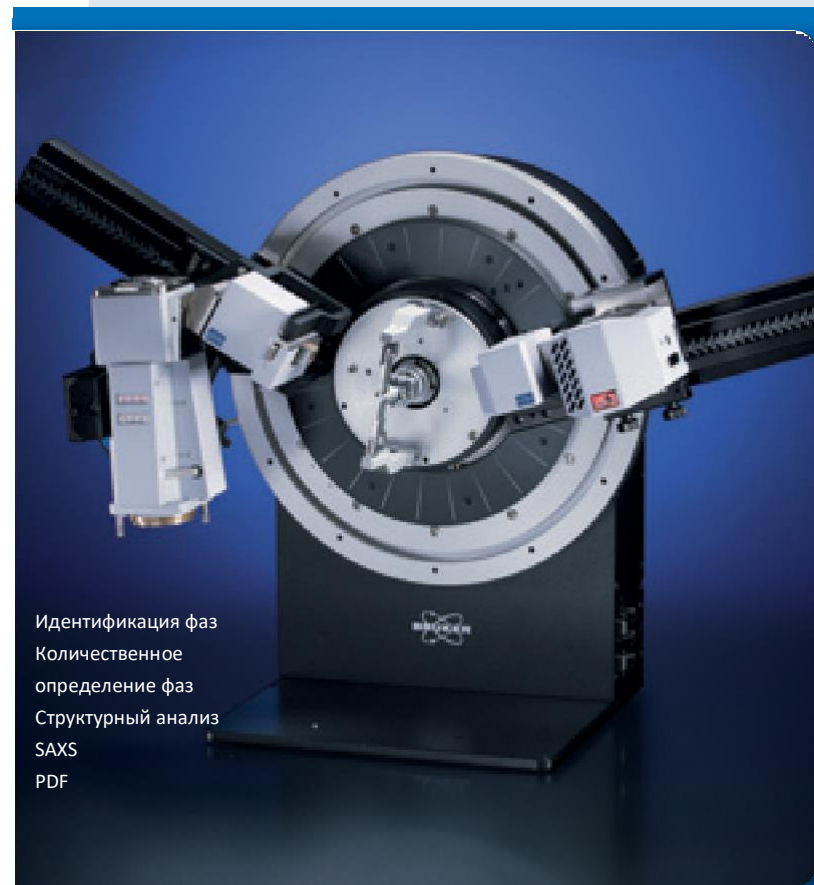
Капиллярная геометрия с монохроматором Иогансона для чистого излучения K\alpha_1 и с детектором LYNXEYE
