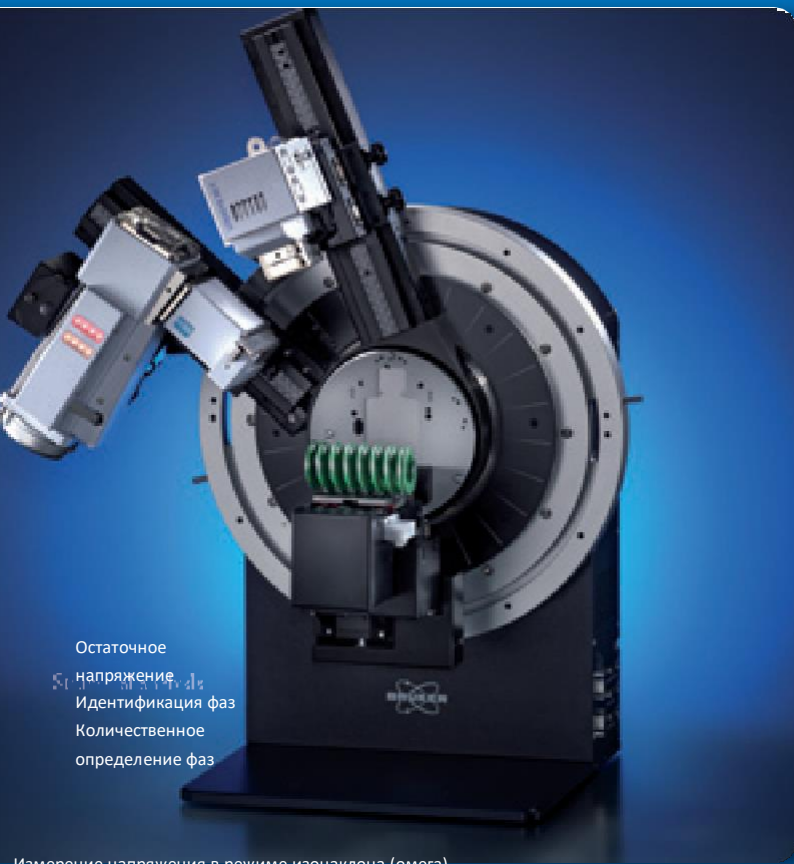
Измерение напряжения в режиме изонаклона (омега)
