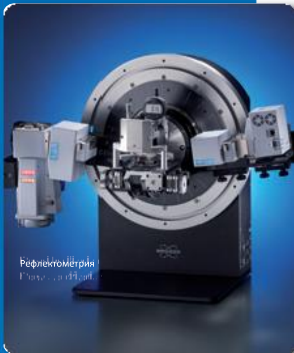
Рефлектометрия, установка TRIO/TWIN с детектором LYNXEYE XE-T в режиме 90°
