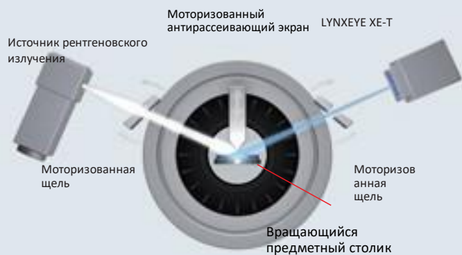
Геометрия Брэгга-Брентано с детектором LYNXEYE XE-T и моторизованным антирассеивающим экраном
